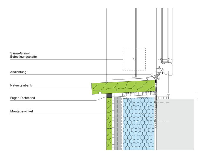
Der Anschluss des Fensterrahmens an den angrenzenden Bauteil muss warmseitig luftdicht ausgebildet werden. (SIA Norm 331 Fenster)
