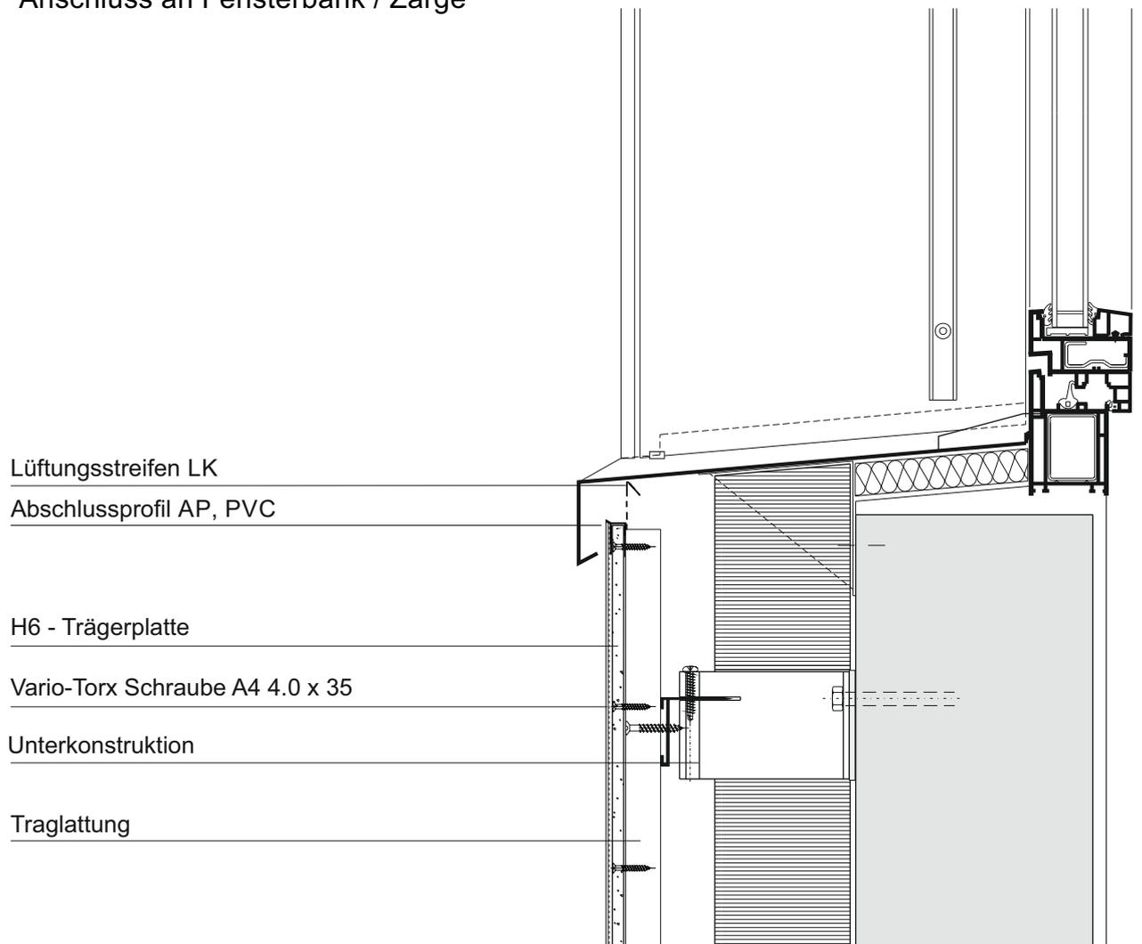
Der Anschluss des Fensterrahmens an den angrenzenden Bauteil muss warmseitig luftdicht ausgebildet werden. ( Norm SIA 331 Fenster )
